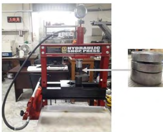
Fig. 3.2 Hydraulic press and die set.
