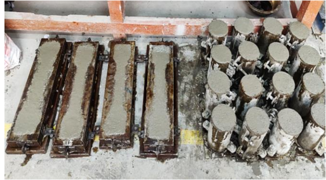
(d) Casting of Dog Bone Specimens and Cylinders
