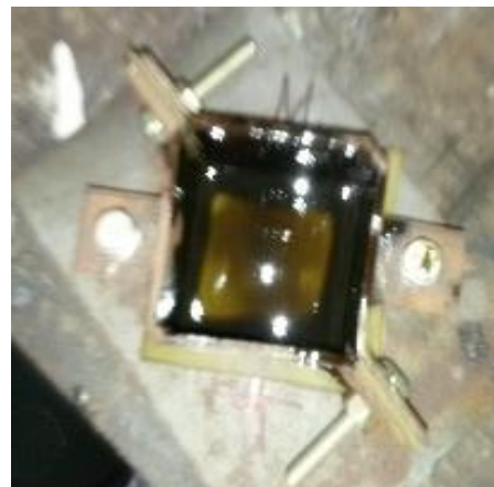
(d) Lubricating the cube
