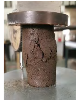
(d) Bulging Failure
